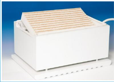
Finfiltret filtrerar t.ex. pollen och damm från uteluften och den skall bytas årligen. För att byta filtret lyfts anläggningen ner från väggen och filtret lösgörs bakvägen.
